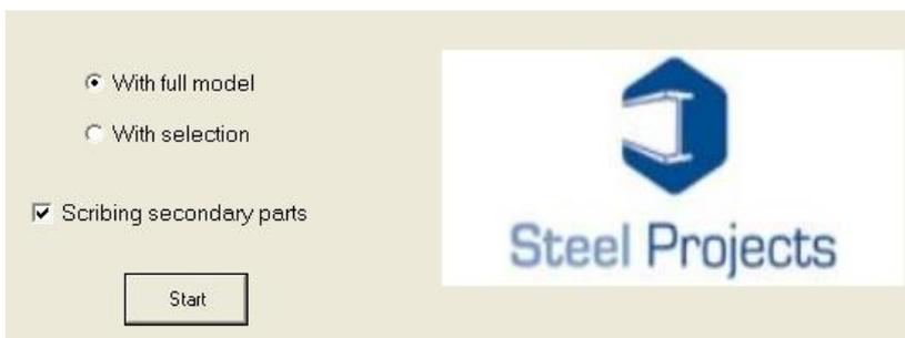
Два переключателя With full model (С полной моделью) и With the selection (С выбором) позволяют пользователю создавать разметку или полной модели, или конкретных элементов, выбранных непосредственно в модели.
